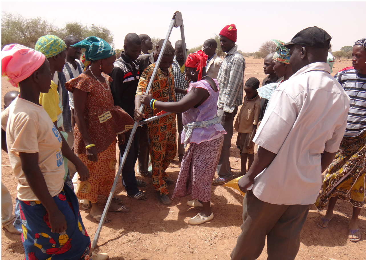
Photo 1 : Des membres du personnel de l'ANSD facilitent une formation d'agriculteur à agriculteur sur l'utilisation d'un niveau A-frame pour tracer les contours des structures de conservation du sol. Crédit : ANSD
